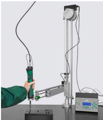
Braccio Cartesiano con dispositivo di rilevazione della posizione
