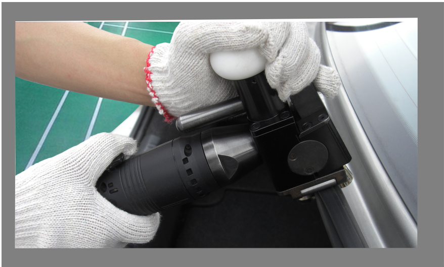
型号：ATV-100SR 汽车密封条滚压装置
